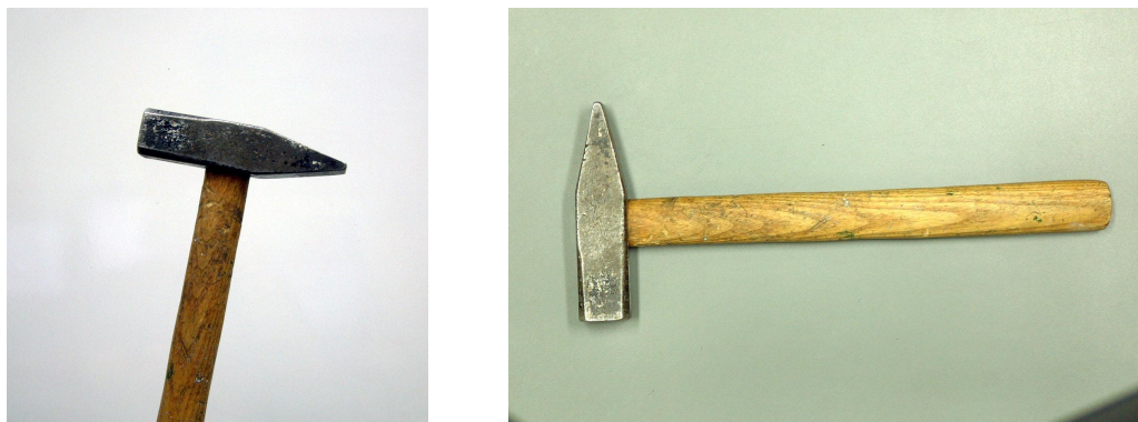
Abbildung 6.28: Trainingsbilder des Objektes Hammer . Links: Aus diesem Trainingsbild kann eine Modellansicht gelernt werden, mit der eine Erkennung möglich ist. Rechts: Durch den Schattenwurf ist die robuste Extraktion der relevanten Bildmerkmale nicht möglich und eine Erkennung mit der damit erzeugten Modellansicht scheitert.
