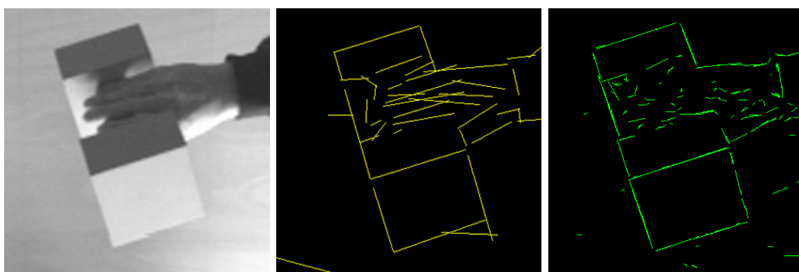
Abbildung 6.6: Gruppierung von Kantenelementen. Links: Originalbild in der Auflösung 307 \times 319 Pixel. Mitte: Gruppierungsergebnis nach der Methode von A. Pope. Rechts: Gruppierungsergebnis durch das schnellere, Hough-basierte Verfahren.
