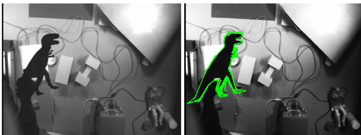
Abbildung 6.22: Links: Testbild mit Abbild des Objektes Dinosaurier . Rechts: Testbild mit überlagertem Erkennungsergebnis (grün: Initialmerkmale der Modellansicht).
